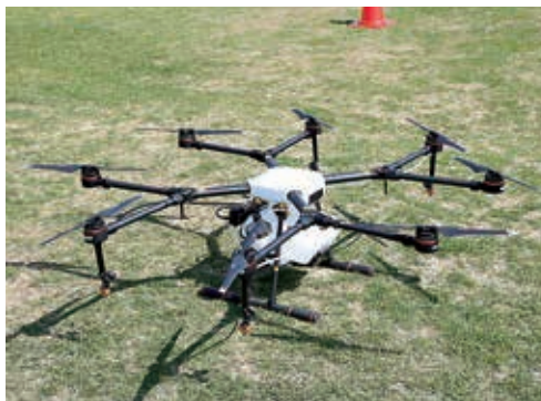
最新鋭散布用ドローン (DJI製AGRAS MG-1)
