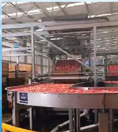
コンテナを反転し、果実を洗浄層へ入れる
