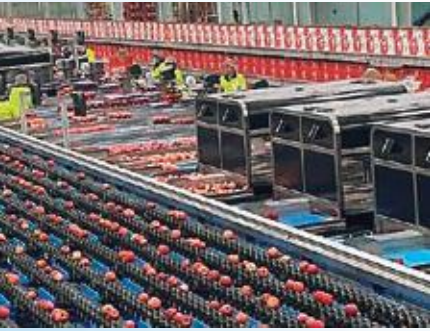
AI知能を搭載したセンサーカメラによって選果される
