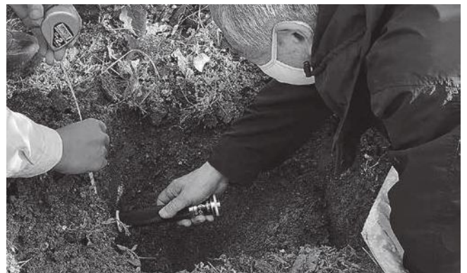
山中式硬度計で土の硬度を図る猪股専務理事
