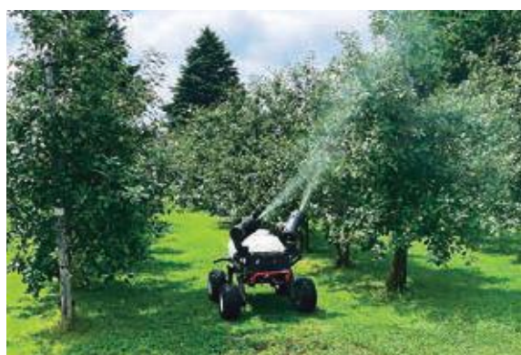
ノズルが上下回転し、散布量も豊富
