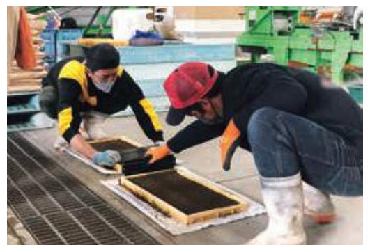
土を手作業でならしている様子
